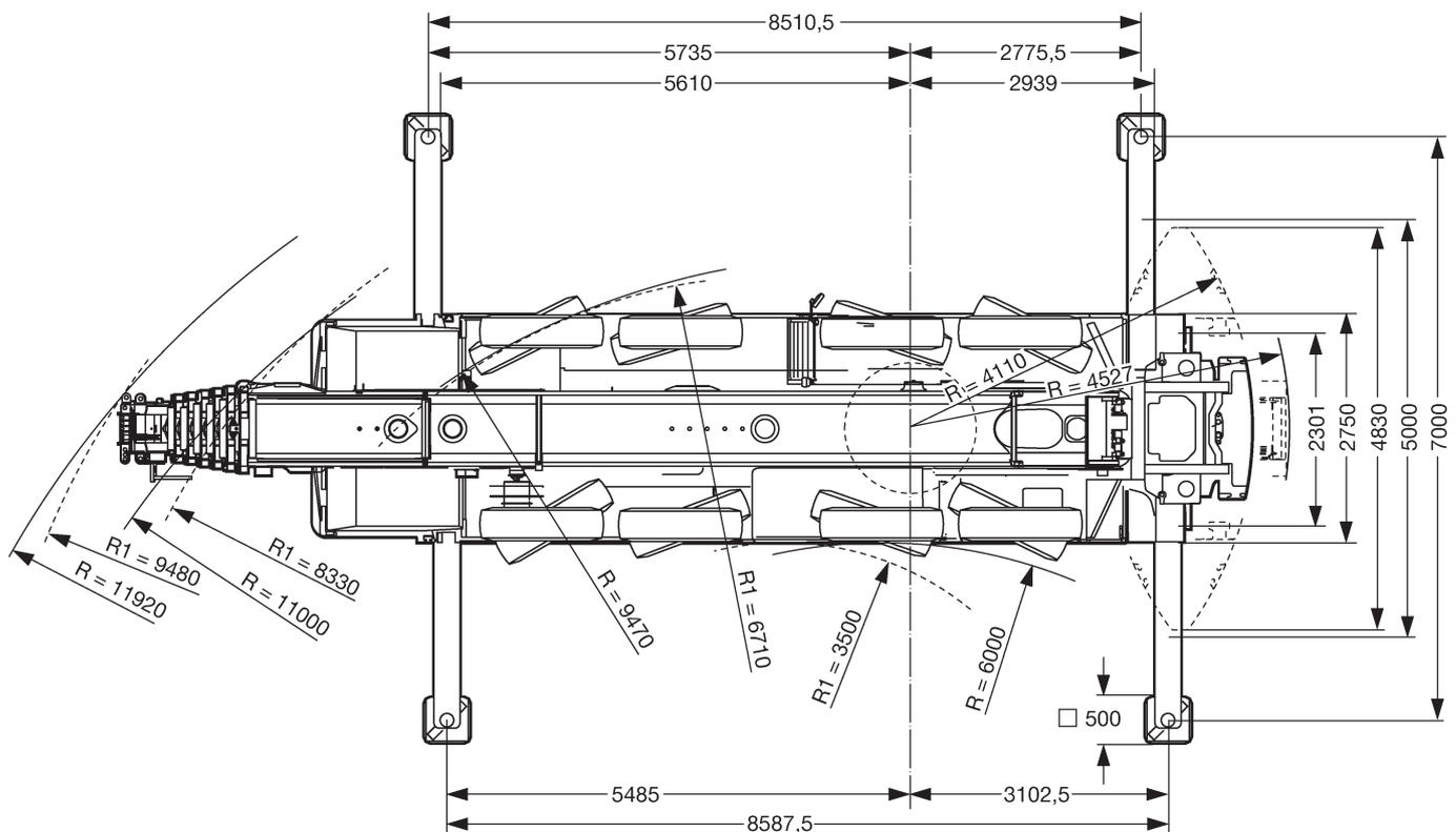
R<sub>1</sub> = Allradlenkung · All-wheel steering · Direction toutes roues · Tutti gli assi sterzanti · Dirección en todos los ejes · Поворот всеми колесами
